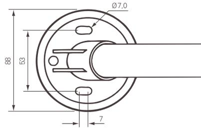
Alle Ergogrip Haltegriffe bestehen aus einem Stahl- oder Edelstahlrohr, einem Flansch aus Kunststoff und einer Kunststoffabdeckung. Durch die 60° Krümmung des Rohres ist es leichter, sich festzuhalten. In Verbindung mit dem Flansch hat der Ergogrip eine durchgängig glatte Form, die festen Halt bietet.
